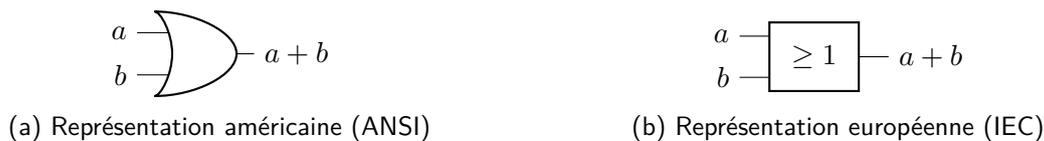
**Fig. 3** – Représentations schématiques de la porte OR
