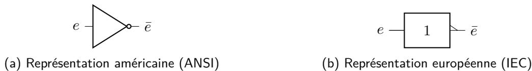
**Fig. 1** – Représentations schématiques de la porte NOT
