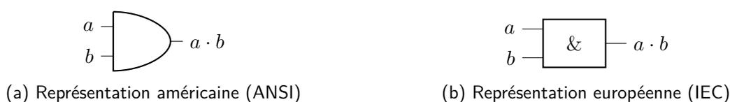
**Fig. 2** – Représentations schématiques de la porte AND
